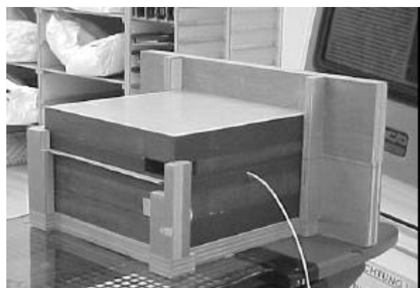
Fig. 1 Das QS-Phantom mit Ionisationskammer und Film (Kodak X-OmatV)
